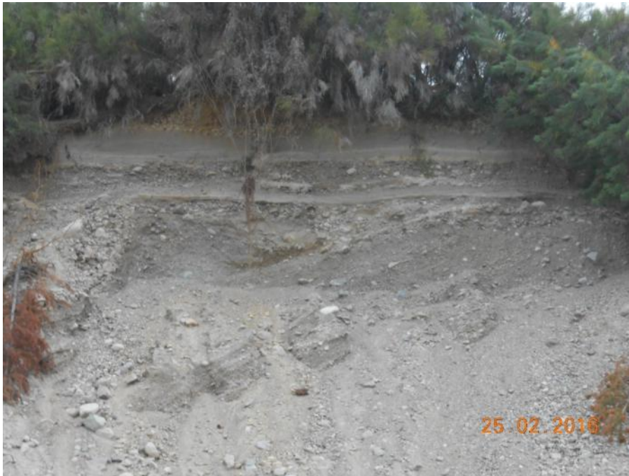
Foto n° 14. Frente de explotación de la cantera. Niveles gruesos imbricados en la base. Por encima Alternancia de depósitos finos y gruesos en posición horizontal.
